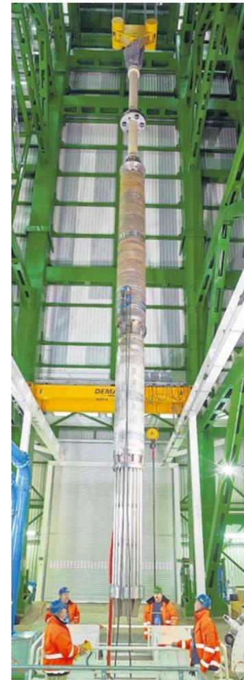
Riesige Tauchpumpen – 12 m lang und 20 t schwer – fördern das Grubenwasser künftig mit rund 80 bar nach oben. In Walsum ist bereits die erste dieser neuen Pumpen im Einsatz. Foto: RAG
